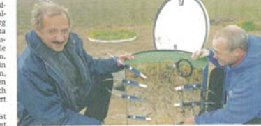
Landwirt Hartmut Leddig und Erik Borg, Techniker der DLR, begutachten die Versuchsanordnung von Tensiometer-Sonden.
